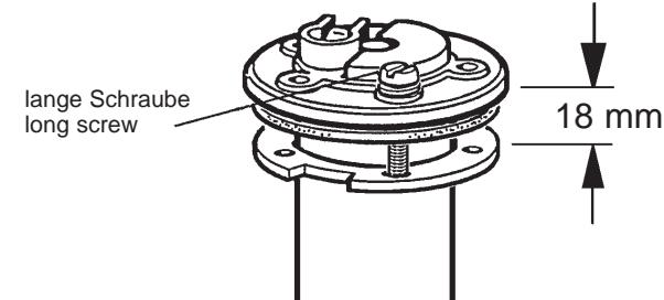
mit Schlitz zuerst einsetzen
