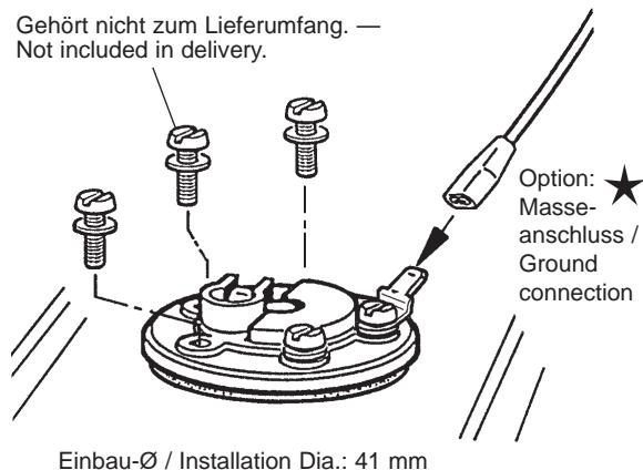
Einbau-Ø / Installation Dia.: 41 mm
