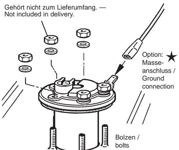
Einbau-Ø / Installation Dia.: 41 mm
