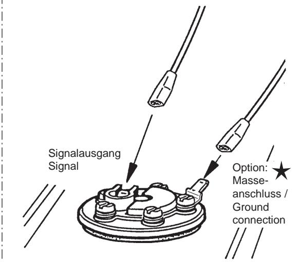
Standard-Tauchrohrgeber, Flanschlochkreis Ø 54 mm
