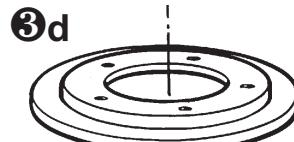
Tankflansch zum Anschweißen
